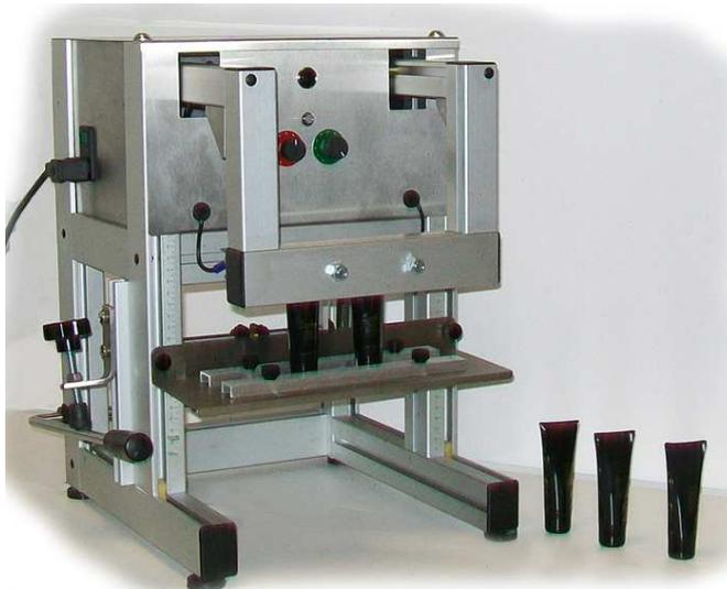
La saldatrice VTBmini è la versione compatta da banco del modello VTB/T, saldatrice per la chiusura di tubetti in plastica, con resistenza saldante da 6mm su entrambe le ganasce e forte pressione meccanica di schiacciamento.
